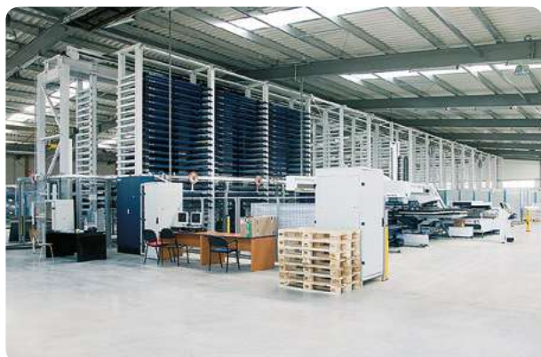
automatizovaný sklad plechů a polotovárů
