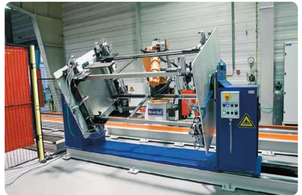
robotické svářecí pracoviště stojanových rozvaděčů
