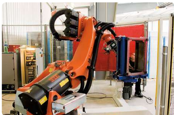
robotické pracoviště pro bodové sváření nástěnných rozvaděčů
