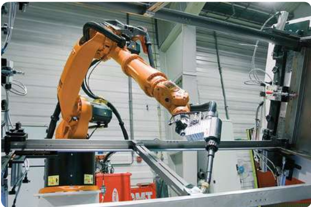
robotické svářecí pracoviště stojanových rozvaděčů
