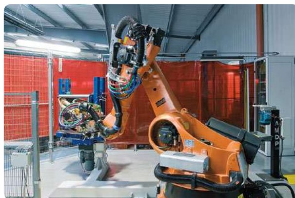
robotické pracoviště pro bodové sváření nástěnných rozvaděčů
