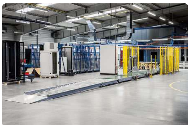
montážní linka stojanových rozvaděčů
